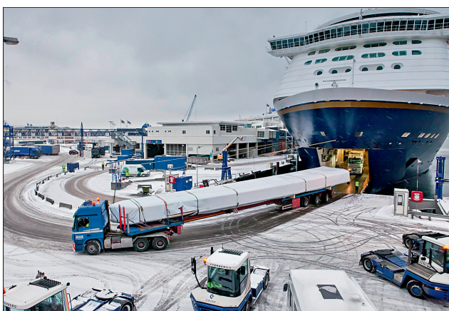
Für das Terminalgebäude waren dreißig, bis zu 52 m lange LKW-Sondertransporte, für das Pier 20 Transporte notwendig. Sie erfolgten per LKW in sieben Nachtstunden von Velppe (Niederrhein) über Kiel und die Linien-Fähre (Color-Line) nach Oslo. Foto: Derix/Poppensieker & Derix
