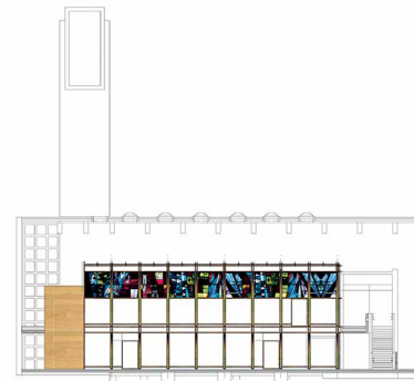
Abb. 10: Seitenschnitt mit gläserner Holz-Skelettkonstruktion
